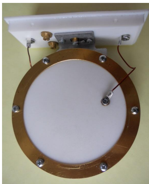
Rys. 8.4. Widok kondensatora po suszeniu i impregnacji olejem
