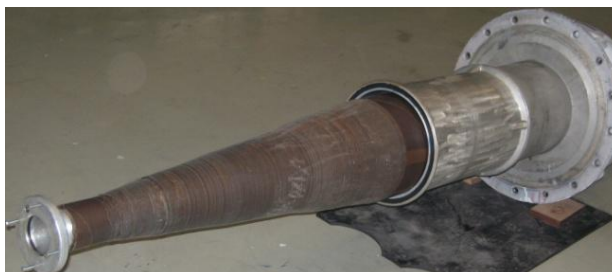
Rys. 3.2. Stożkowe ukształtowanie dolnej części rdzenia izolatora 400 kV [fot. własna]
