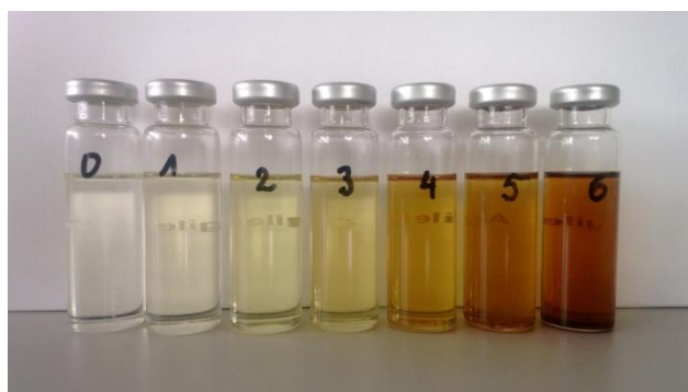
Rys. 8.7. Wygląd kolejnych próbek oleju, pobieranych podczas starzenia
