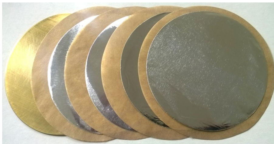
Rys. 8.3. Widok elektrody mosiężnej, krążków papieru i folii aluminiowej użytych do budowy kondensatora
