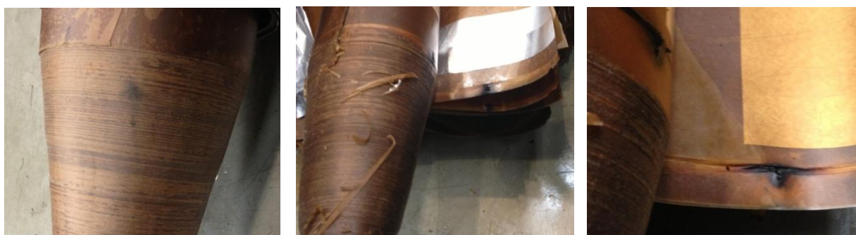
Rys. 8.12. Widok izolatora 420 kV, w którym rozwijało się przebicie wewnętrznej warstwy papieru izolacyjnego [fot. własne]
