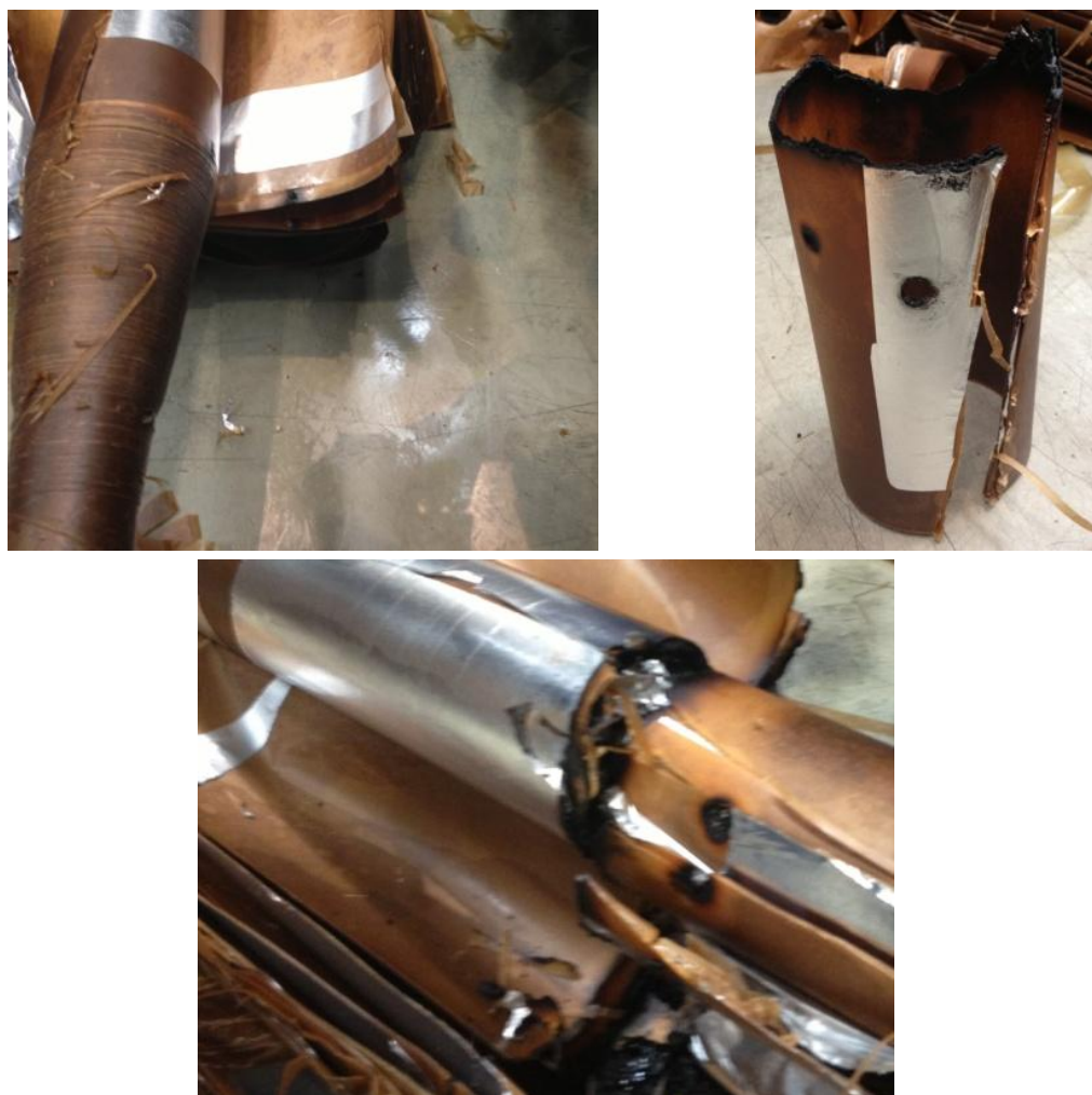
Rys. 10.12. Dokumentacja potwierdzająca przepalenie wewnętrznych warstw papieru i folii aluminiowej rdzenia kondensatorowego izolatora
