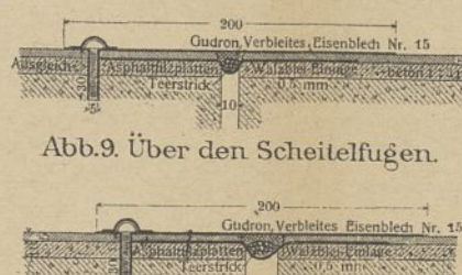
Abb. 10. Über den Kämpferfugen der Strompfeiler.
