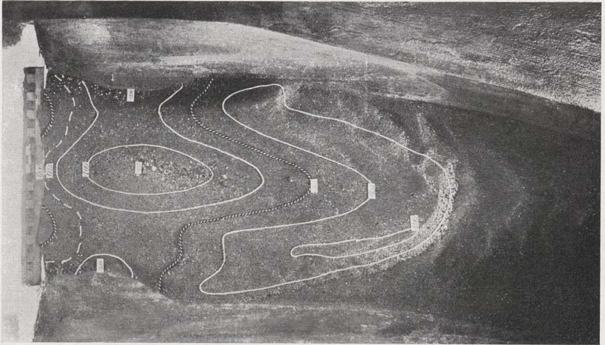
Abb. 5. Zahnschwelle mit Kolken nach dem Modell.
