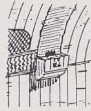
Abb. 5. Geputzte Auskragung für den Querbalken.
