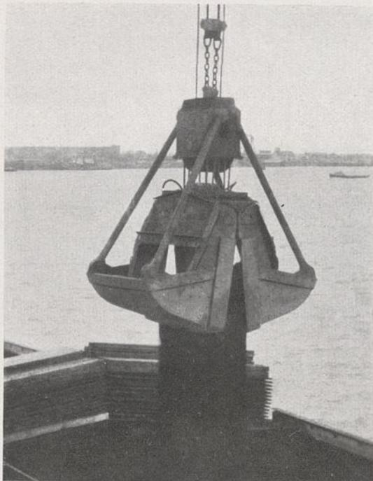
Abb. 21. Erzgreifer der Demag-Bauweise.
