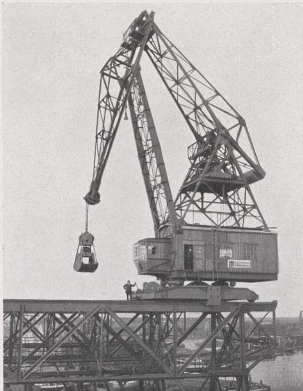
Abb. 50. Drehkran mit eingezogenem Wipplager.
