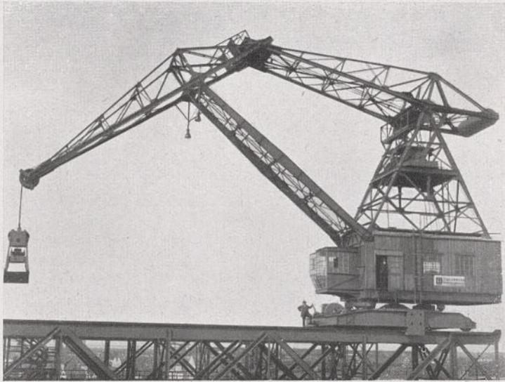
Abb. 29. Drehkran mit ausgefahrenem Wipplager.
