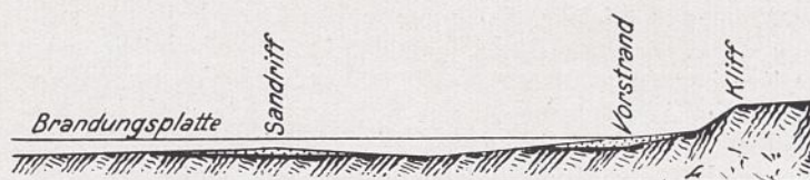
Abb. 5. Strandquerschnitt bei Cranz. M. 1:20000 und 1:2000.
