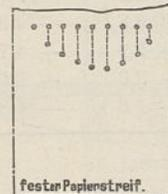
Abb. 14. Aufzeichnung der senkrechten Durchbiegungen auf Papierstreifen an den Lattenvorrichtungen.
