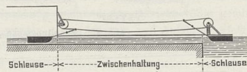
Abb. 24. Schiffszug mit Seilbetrieb.
