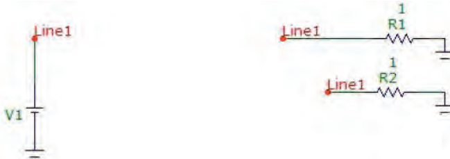
Rys. 3.7. Tworzenie połączeń bezsieczkowych między różnymi punktami węzłowymi wykorzystywane do budowy w środowisku MicroCap i Pspice złożonego modelu układu oddechowego podczas przerwania przepływu powietrza
