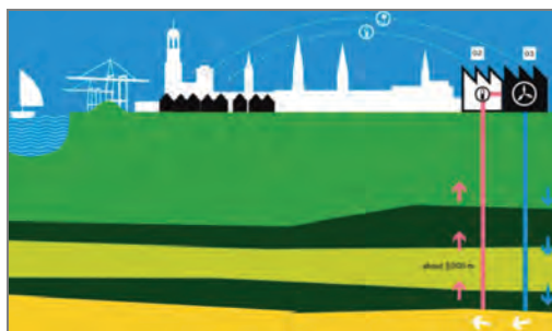
Il. 23. Schemat pozyskania energii geotermalnej, Wilhelmsburg/„Tiefengeothermie Wilhelmsburg” (infografika IBA)
