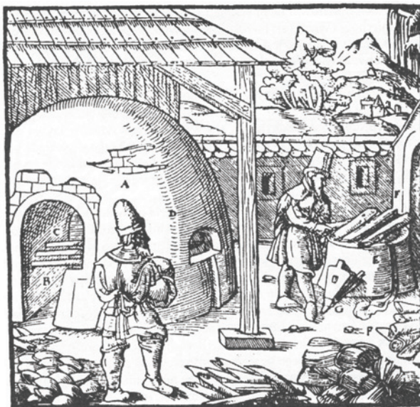
Rysunek 2. Polsko-węgierski piec kupelacyjny. Literą D oznaczono otwór do zdejmowania glejty
