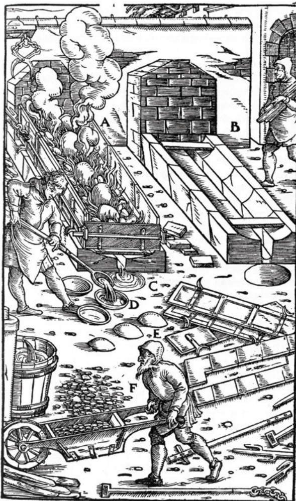
Rysunek 1. Piec rynowy do odtapiania ołowiu wraz z domieszkami srebra od stopu z miedzią
