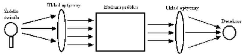
Rys. 29. Zasada pomiaru turbidymetrycznego [112]
