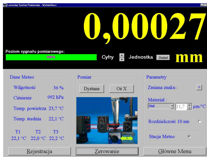
Rys.4.2.50. Okno podstawowe systemu pomiarowego umożliwiające sprawdzenie aktualnych wartości temperatur, ciśnienia i wilgotności, wykonanie podstawowych pomiarów przesunięcia oraz wykonanie kalibracji układu optycznego (retroreflektora pomiarowego i odniesienia z kostką polaryzacyjną).
