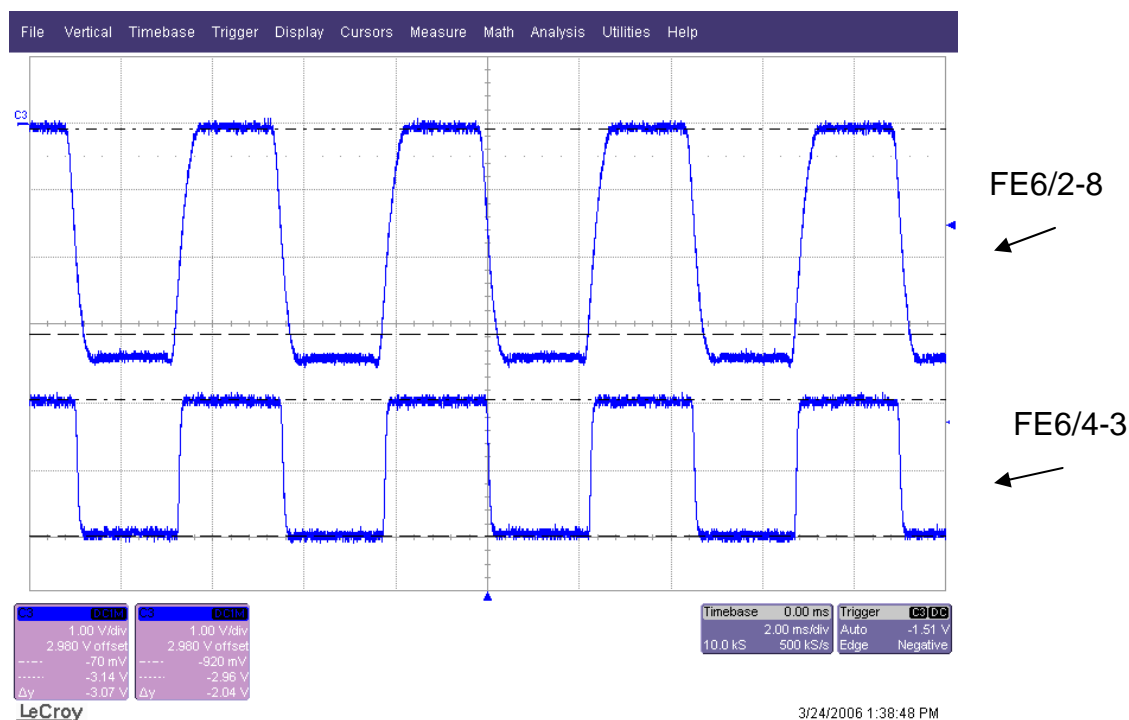
Rys.4.2.11. Przebieg sygnału na oscyloskopie w poprawnie ustawionym układzie pomiarowym Rys.4.2.9 [3.09]. Duża stromość zboczy przebiegu oraz duża amplituda uzyskanego sygnału świadczą o dobrym kontraście komórki ciekłokrystalicznej. Przedstawione przebiegi dla komórki charakterze płytki ćwierćfalowej oraz półfalowej.
