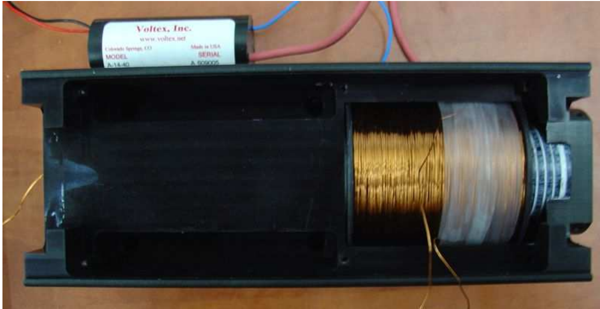
Rys.4.2.17. Obudowany laser LGR7655S z cewką do wyznaczenia zależności częstotliwości Zeemana laserów He-Ne od wartości pola magnetycznego.
