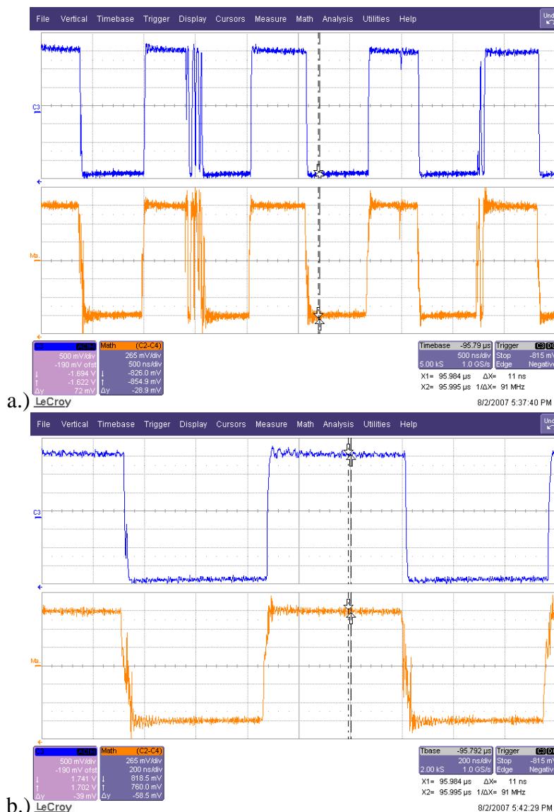
Rys.5.1.5. Zakłócenia referencyjnego sygnału Zeemana wywołane przenikaniem sygnału z układu taktującego komórkę z ciekłym kryształem w układzie stabilizacji częstotliwości lasera.
