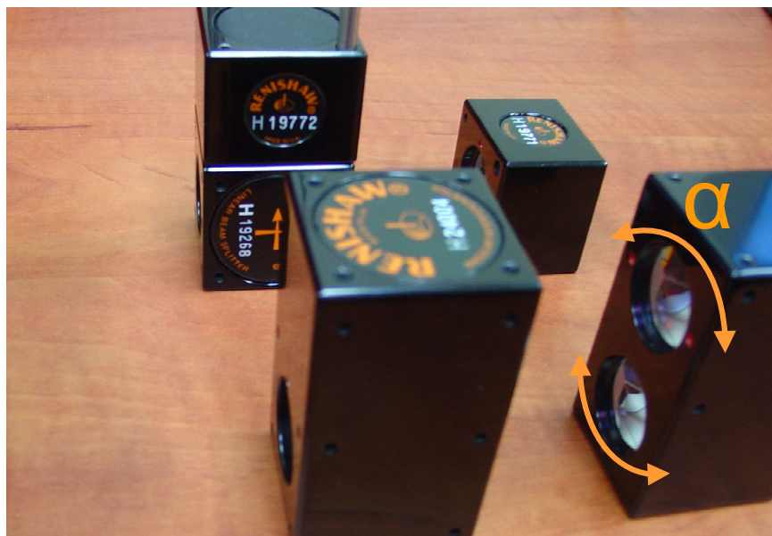
Rys.4.2.56. Optyka do pomiarów kątowych firmy Renishaw (lub inna) w zestawie z interferometrem z rozszerzeniem proponowanym przez autora umożliwia pomiar błędu „roll”.
