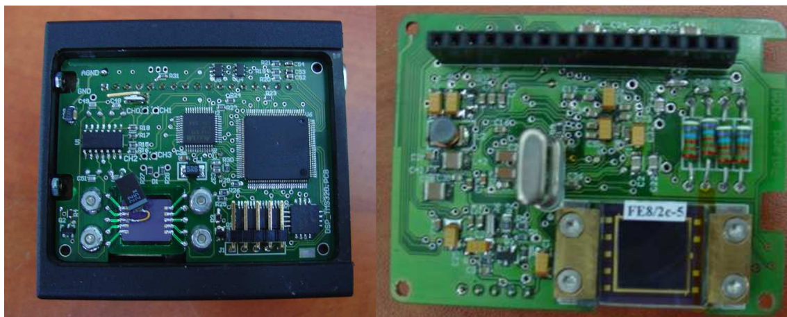
Rys.4.2.43.4. Zdjęcia układu detekcji pozycji z detektorem czteropolowym, Kryształem SSFLC FE8/2c-5, układami buforowania, czterokanałowym przetwornikiem a/c oraz procesorem sterującym. Widoczne dwie wersje detektorów czteropolowych o różnych wymiarach powierzchni aktywnej (5x5mm oraz 10x10mm). Pomiedzy komórką z kryształem a detektorem znajduje się polaryzator ustawiony pod kątem 45° w stosunku do krawędzi detektora.
