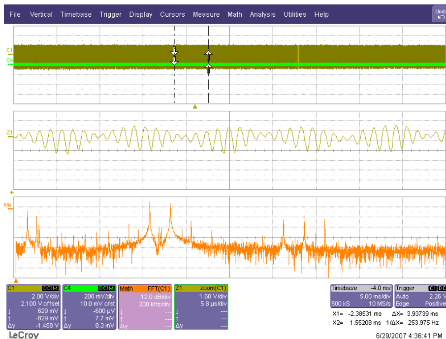
Rys.4.2.15. Charakterystyka częstotliwościowa lasera He-Ne LGR7655S w silnym polu magnetycznym.
