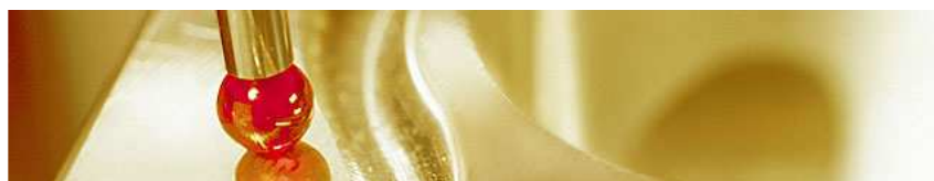
Rys.1.2.10. Końcówka pomiarowa sondy dotykająca mierzonego przedmiotu [1.02].
