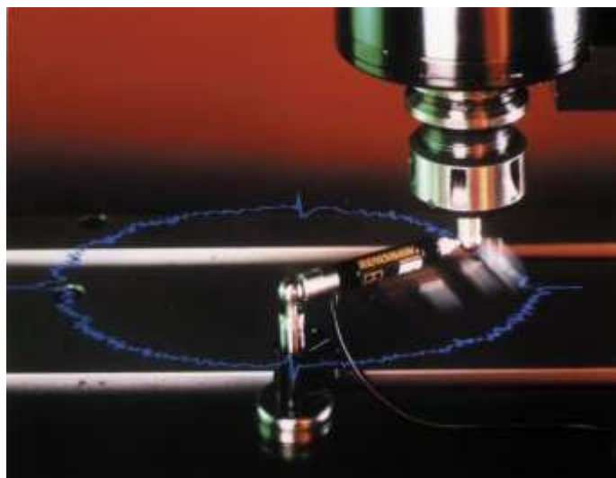
Rys.1.2.35. System pomiarowy „ballbar” firmy Renishaw oraz hipotetyczny wykres kołowości maszyny.
