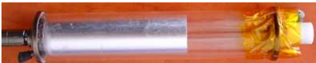
Rys.4.2.2. Zdjęcie lasera He-Ne LGR7655S produkcji firmy Lasos GmbH (Niemcy). Anoda lasera zaizolowana taśmą izolacyjną wysokonapięciową oraz teflonowym „kubkiem”. Przy anodzie widoczne rezystory balastowe.
