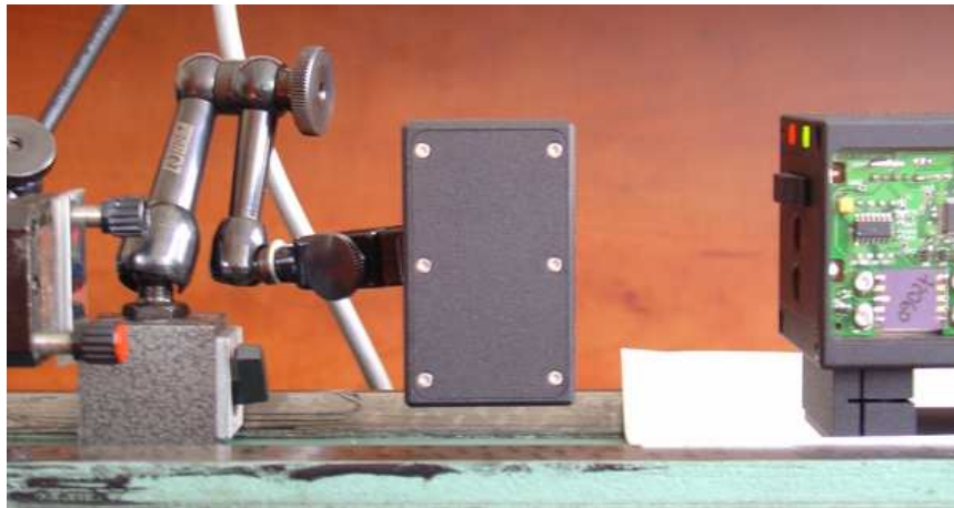
Rys.4.2.48. Interferometr laserowy w konfiguracji do pomiaru przemieszczenia od zwierciadła. Oś główna lasera – oś X.
