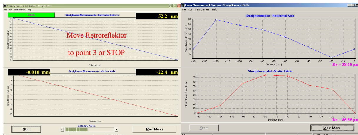
Rys.4.2.55. Interferometr laserowy w konfiguracji do pomiarów prostoliniowości lub/i płaskości powierzchni (dwóch osi) oraz przykładowy wynik pomiaru.
