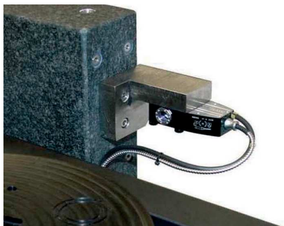
Rys.1.2.27. Głowica światłowodowego interferometru laserowego RLU10 90° firmy Renishaw w układzie pomiarowym.
