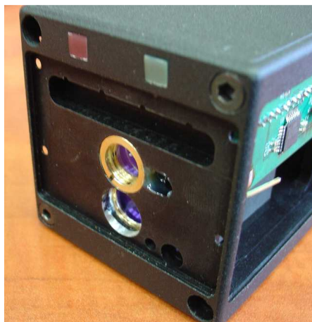
Rys.4.2.21. Zdjęcie układu mocowania płytki ćwierćfalowej oraz półfalowej do zamiany polaryzacji kołowej wiązki laserowej na liniową.
