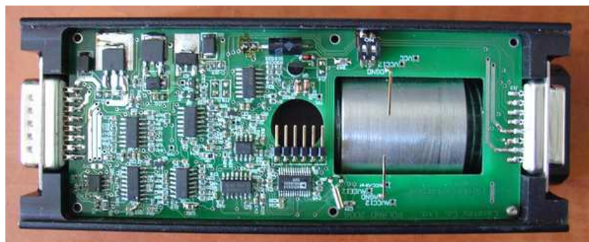
Rys.4.2.36. Zdjęcie układu stabilizacji lasera He-Ne w oparciu o równowagę dwóch składowych wiązki laserowej. Widoczny magnes neodymowy ze zwrótem magnetyczną.
