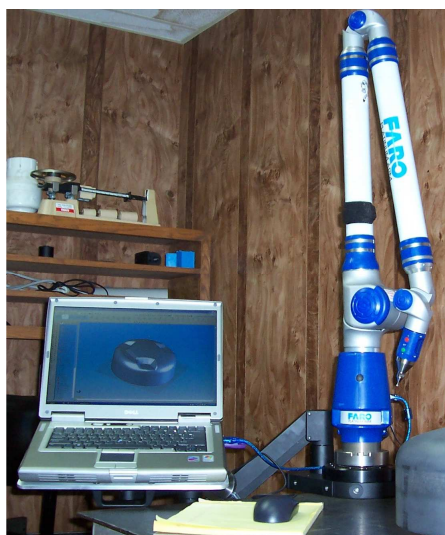
Rys.1.2.12. Przenośna współrzędnościowa maszyna pomiarowa typu Titanium Arm firmy FARO o zakresach pomiarowych do 3700mm [1.13].
