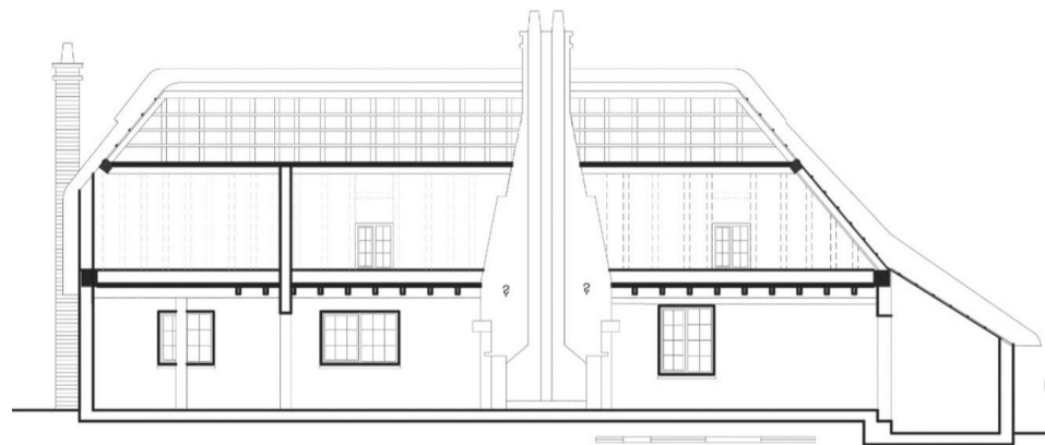
II. 5. Przekrój typowego domu M&S (rys. M.M. Kołakowski)
