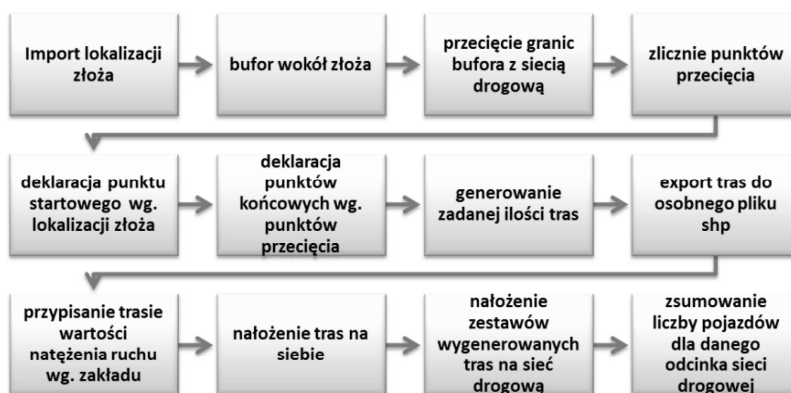
Rys. 2. Schemat pracy narzędzi GIS w procesie wyznaczania tras wywozów Fig. 2. GIS tools working scheme, in haulage routes determination process
