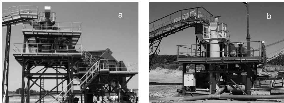
Rys. 3. Przykładowe klasyfikatory K150 (a) i K100 (b) (Matusiak i in. 2012) Fig. 3. Example of K150 (a) jig and K100 jig (b) (Matusiak et al. 2012)
