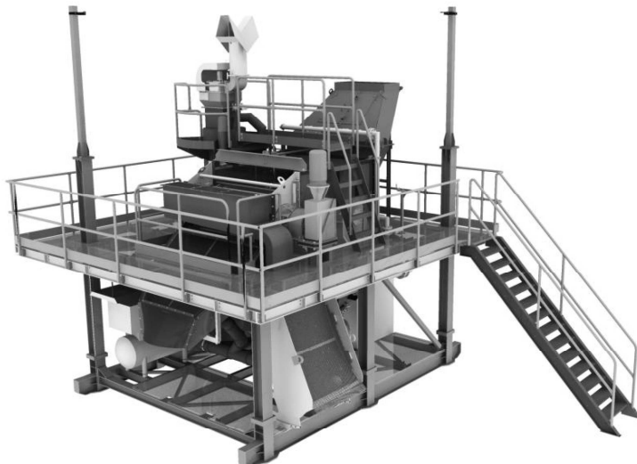
Rys. 1. Klasyfikator K101 na podbudowie mobilnej (Matusiak, Kowol 2013, Matusiak i in. 2012) Fig. 1. K101 pulsatory jig on a mobile base
