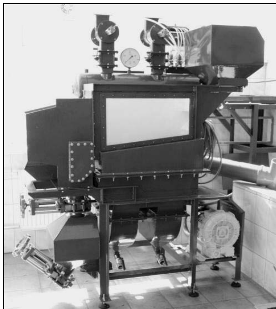
Rys. 1. Stanowisko doświadczalne osadzarki laboratoryjnej Fig. 1. Experimental stand of laboratory jig
