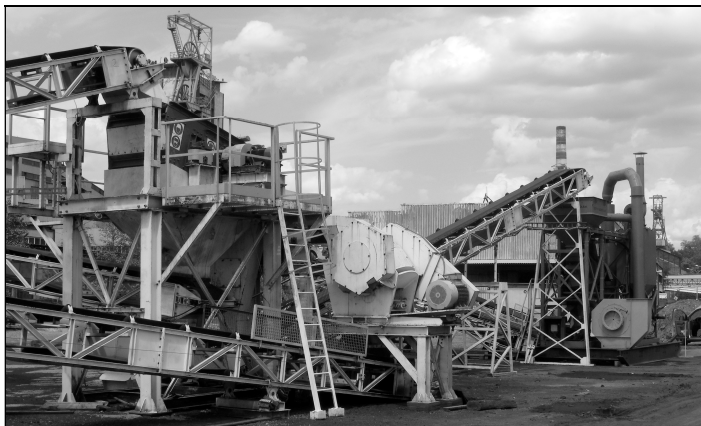
Rys. 3. Instalacja badawcza do suchej separacji; fot. W. Sobko Fig. 3. Research installation for dry separation; photo by W. Sobko
