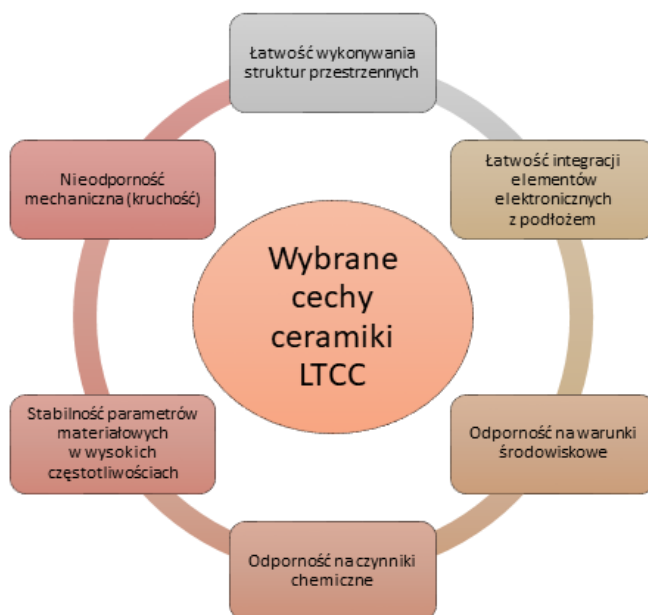
Rys. 2. Wybrane cechy LTCC, istotne z perspektywy wytwarzania układów mikroprzepływowo-mikrofalowych
