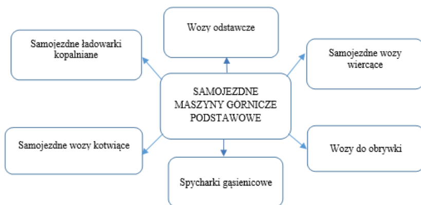
Rys. 2. Klasyfikacja podstawowych maszyn dołowych wykorzystywanych w procesie wydobywania rud miedzi [5]
