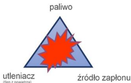
Rys. 1. Schemat powstawania wybuchu [2]
