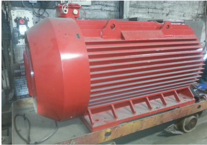
Rys. 1. Zdjęcie silnika synchronicznego z magnesami trwałymi typu S1 560X-4Apm.
