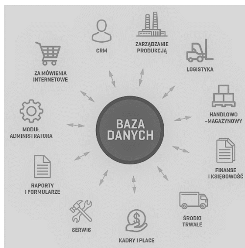
Rys. 4. Modułowa budowa systemu ERP
