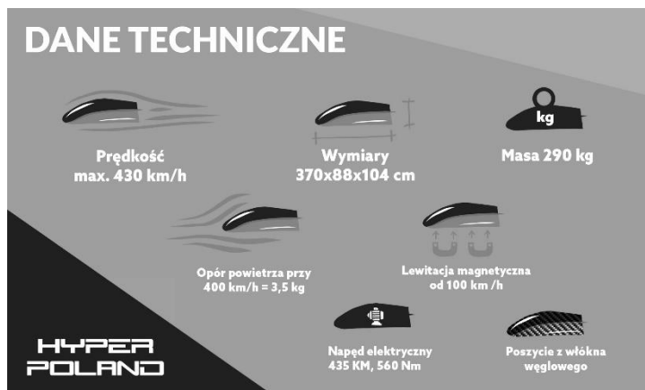
Rys. 3. Dane techniczne kapsuły zaprojektowanej przez Hyper Poland
