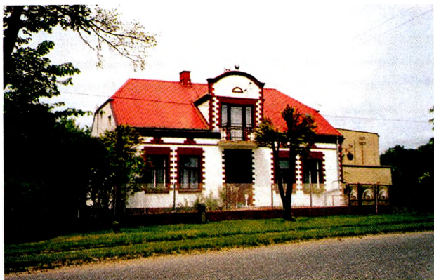
Ryc. 4. Odzworowanie oryginalnej kolorystyki materiału budowlanego – wapienia i cegły – w pomalowanej elewacji budynku w Rędzinach
