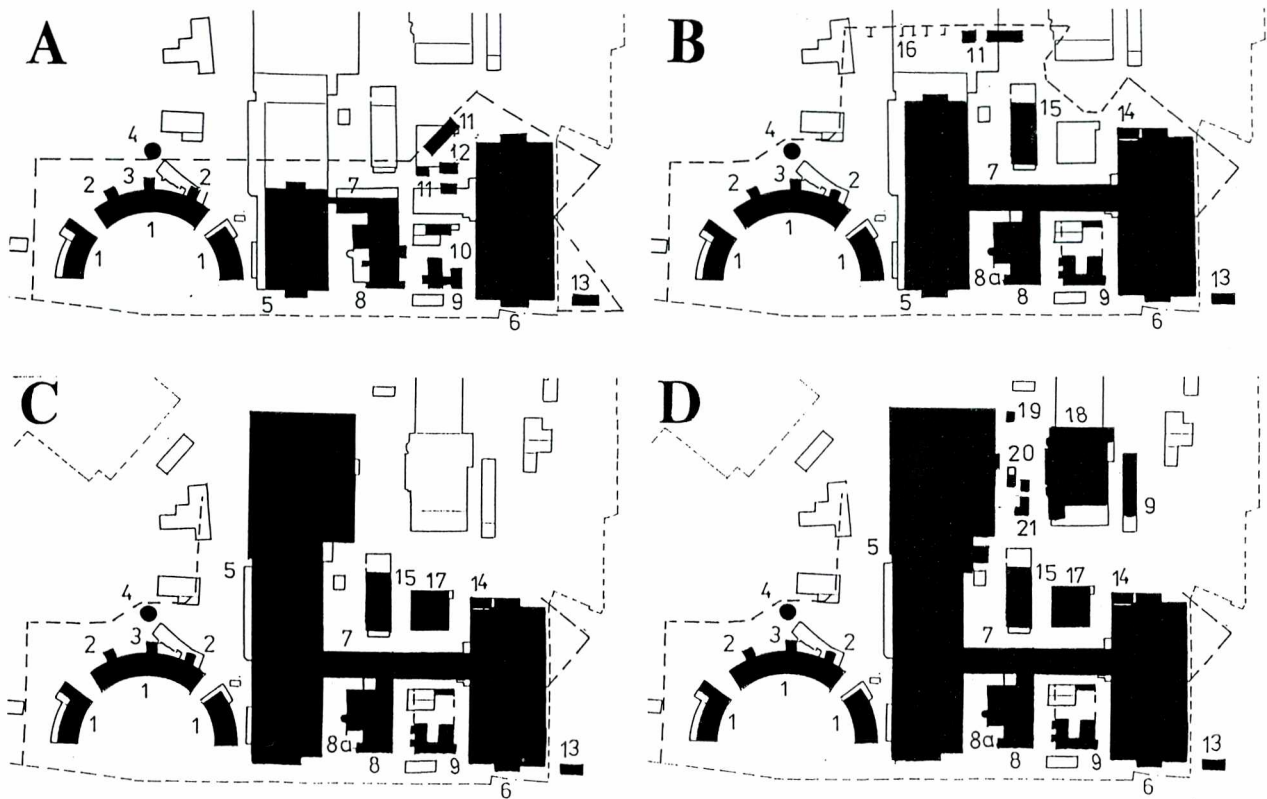
Ryc. 3. Etapy budowy zespołu budynków zaplecza Dworca Nadodrza, obecnego ZNTK. A – od około 1868–1890, B – 1890–1907, C – 1907–1918, D – około 1918, 1 – parowozownia, 2 – pomieszczenie dla maszynistów, 3 – stacja wodna, 4 – wieża ciśnień, 5 – maszynownia, 6 – wagonownia, 7 – tokarnia, 8 – ślusarnia, 8a – maszynownia i kotłownia 9 – magazyn, 10 – tłocznia, 11 – skład drewna, 13 – skład żelaza, 13 – administracja, 14 – stolarnia, 15 – kuźnia miedzi, stolarnia, 16 – skład złomu, 17 – kuźnia, 18 – kuźnia kotłów, 19 – produkcja karbidu, 20 – skład koksu i węgla, 21 – kuchnia, 22 – stołówka i łazienka
