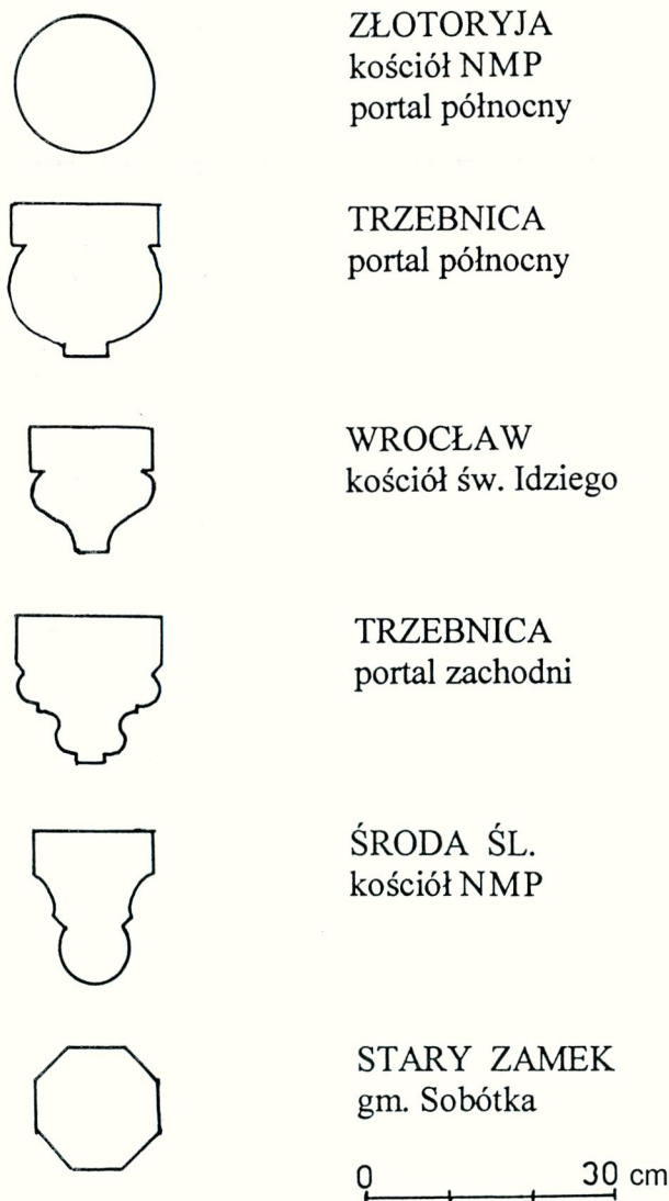
Ryc. 21. Przekroje wałków archiwolty Fig. 21. Cross-sections of the archivolt
