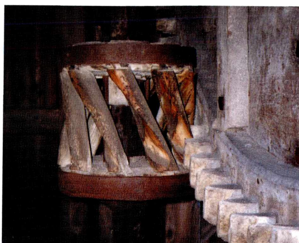
Ryc. 6. Koło cewkowe z cewiami skośnymi (z Szamarzewa) Fig. 6. Winding wheel in Szamarzewo
