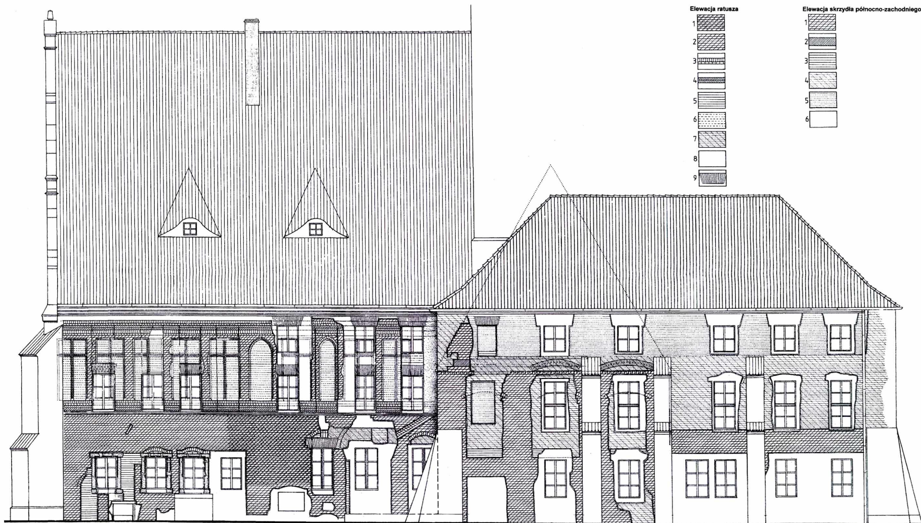
Ryc. 8. Rozwarstwienie murów elewacji północnych bloku ratuszowego. Elewacja ratusza: 1 – mur gotycki z dobrze zachowanym licem, 2 – mur gotycki ze zniszczonym licem, 3 – ucięty gzyms gotycki, 4 – płycina gotycka, 5 – lico blend gotyckich, 6 – mur renesansowy, 7 – mur z trzeciej tercji XVIII w., 8 – mur z połowy XIX–XX w., 9 – nadproża okien z połowy XIX w. Elewacja skrzydła północno-zachodniego: 1 – mur gotycki, 2 – płycina gotycka, 3 – mur renesansowy, 4 – mur z trzeciej tercji XVIII w., 5 – mur z XIX w., 6 – mur z XX w.
