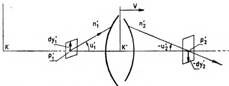
Fig. 2. La marche du rayon lumineux dans le système optique (condition d'Abbe)
