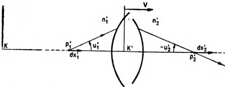
Fig. 1. La marche du rayon lumineux dans le système optique (condition d'Herschel)
