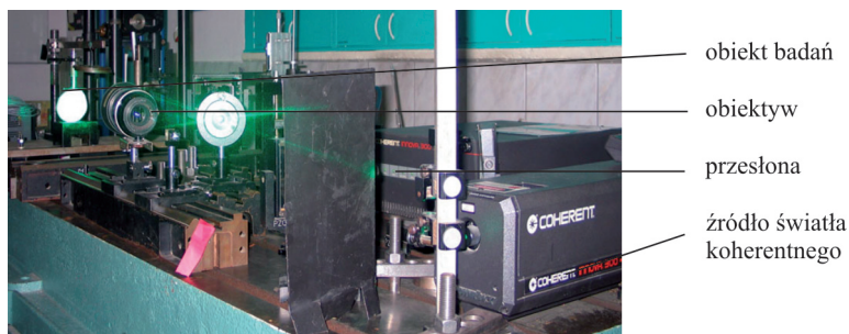
Rys. 6.12. Stanowisko do pomiaru przemieszczeń metodą fotografii plamkowej Fig. 6.12. Experimental station for the displacement measurement using speckle photography
