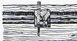
Abb. 88g. Balkenkopf mit Füllholz und Nagelung.
