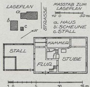
Abb. 222. Trebichow. Grundriss und Lageplan eines Blockhauses.
