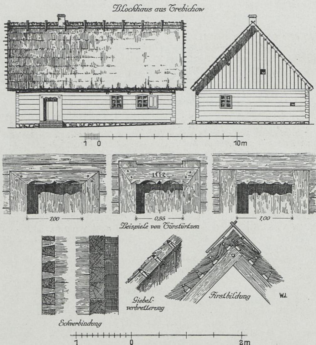
Abb. 223. Trebichow. Längs- und Giebelansicht eines Blockhauses sowie verschiedene Giebelstürze und Dacheinzelheiten.
