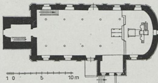
Abb. 1. Baudach. Grundriss der Kirche.
