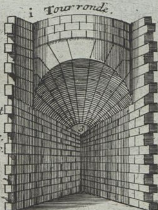
1. Trompe dans l'angle en Tour ronde et réglé.
