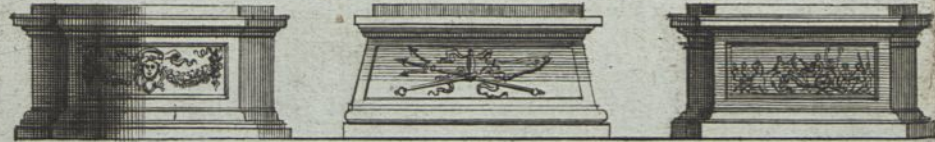
10 P. avec avant corps circulaire . 9 Piedestal en talut . 8 P. avec avant corps droit .
