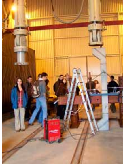
Hala do badań modeli mostów w skali naturalnej – widoczne siłowniki hydrauliczne firmy Schenck
