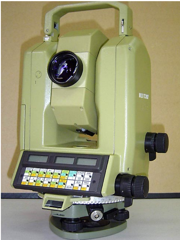
Zdjęcie 4. Precyzyjny tachimetr Leica TC 2002 (mierzy m.in. kierunki i odległość)
