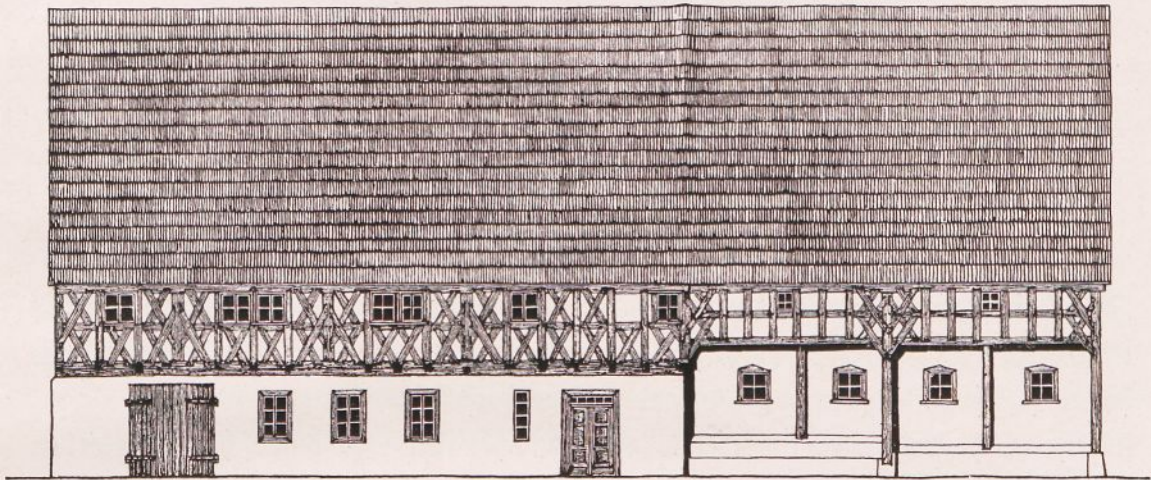
Abb. 12. Längsansicht des Gerichtskretschams in Bärndorf im Riesengebirge. Die Grenze der ursprünglichen Anlage (rechts) zeichnet sich auch in der Dachhaut ab.
