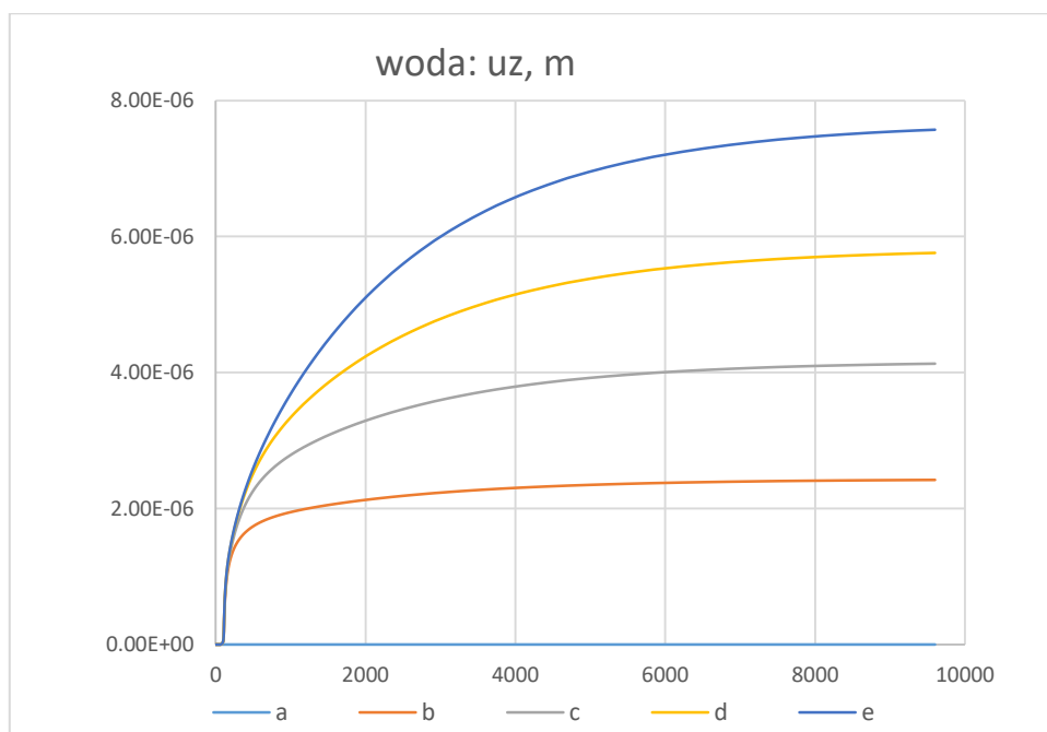
Rysunek 5.14 Przebieg przemieszczeń pionowych w czasie w wybranych punktach próbki dla wody jako płynu porowego
