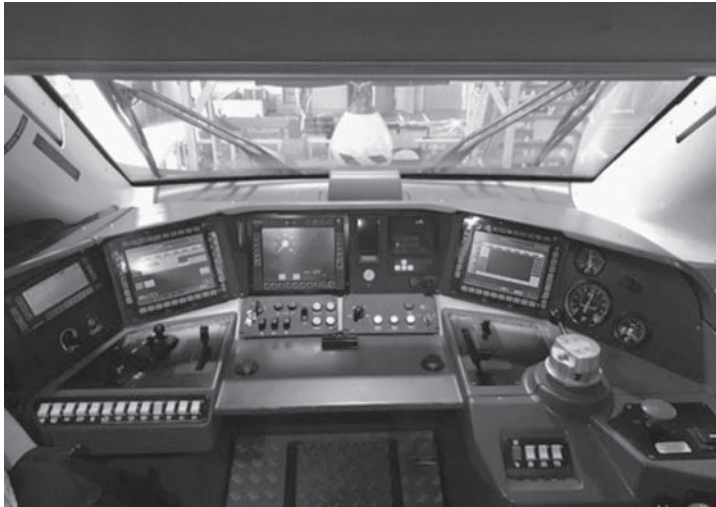
Rys. 5. Ergonomiczny pulpit w kabinie maszynisty składu ED250
