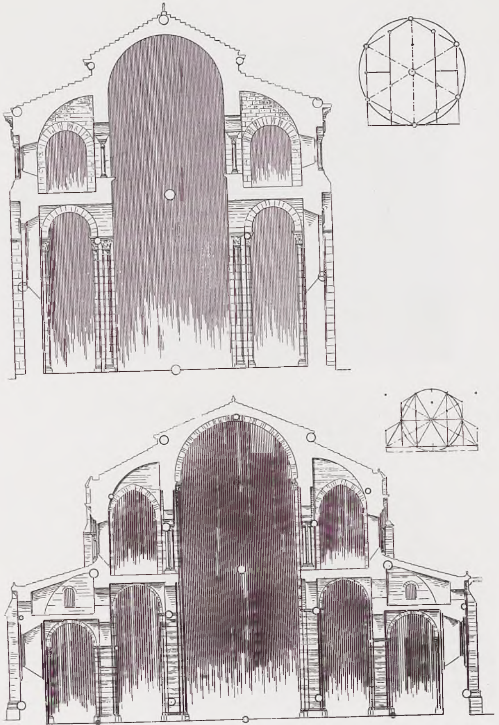
Tafel 54. Oben: Notre-Dame-du-Port zu Clermont-Ferrand, Querschnitt Unten: St. Sernin zu Toulouse, Querschnitt
