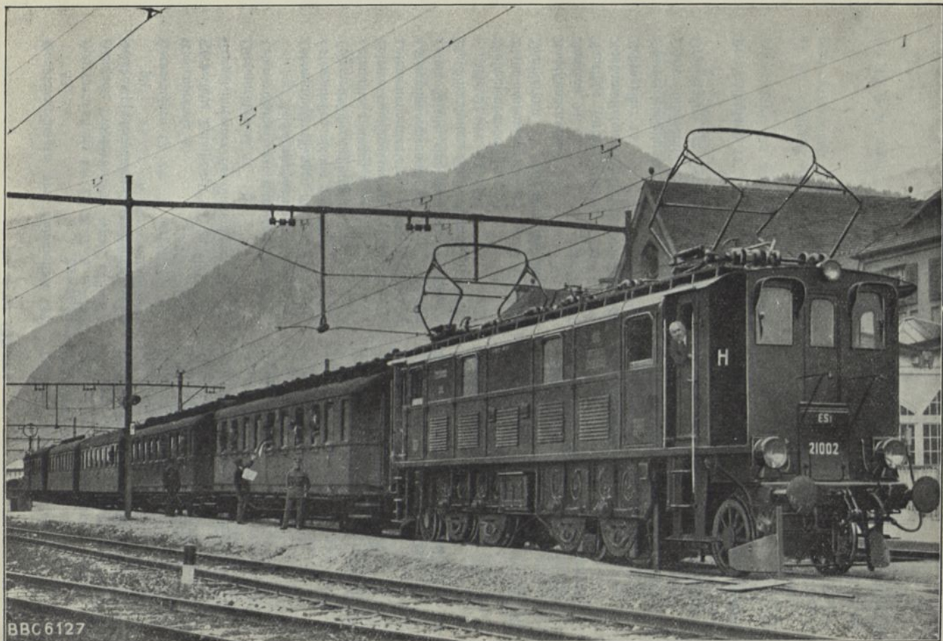
Elektrische Schnellzugslokomotive mit Einzelachsenantrieb, Bauart 1 D 0 1 der Deutschen Reichsbahn vor dem Karwendelexpress. Gebaut von Brown, Boyer & Cie., Mannheim
