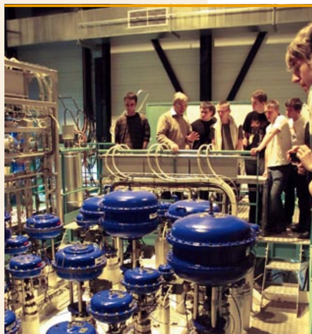
Inż. Vladislav Benda przedstawia studentom automatykę skraplarki helowej (na pierwszym planie widoczne są głowice zaworów kriogenicznych)
