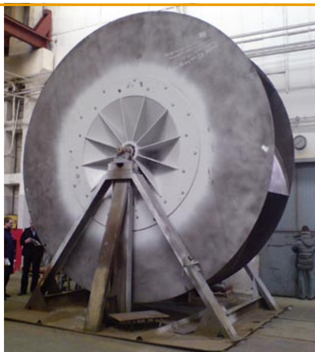
Wirnik wentylatora nowej generacji na stanowisku prób
