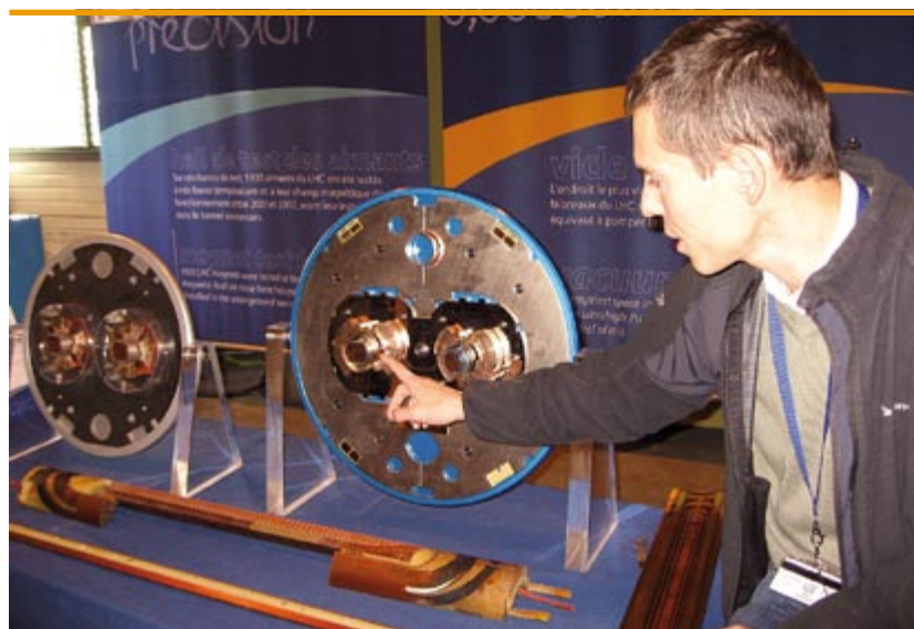
Czesław Fluder przedstawia różnice budowy nadprzewodnikowych magnesów dipolowych i kwadrupolowych akceleratora LHC
