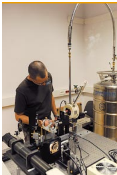
Układ do spektroskopii optycznej pojedynczych kropek kwantowych
