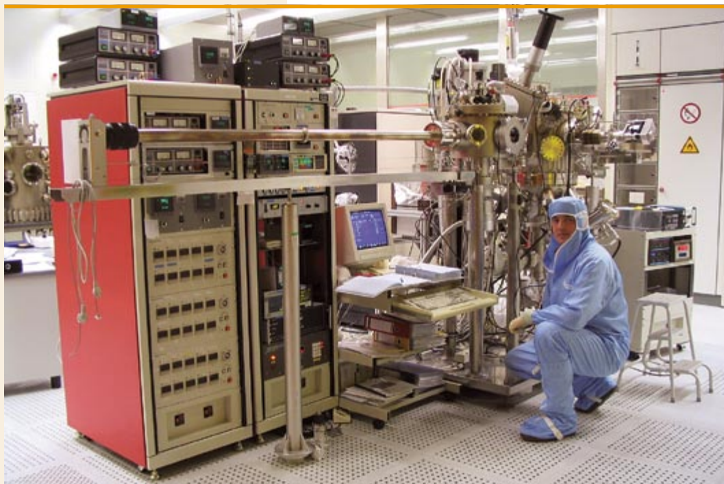
Dr Damian Pucicki przy stanowisku epitaksjalnym MBE w laboratorium Uniwersytetu w Würzburgu
