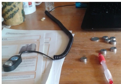
Rys. 177 Rejestratory Ibuttons wraz z portem do programowania i odczytu pomiarów. Fot. Mokrzecka M.
