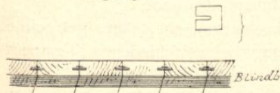
Fußboden mit Hammerstein'schen Stahlplättchen.
