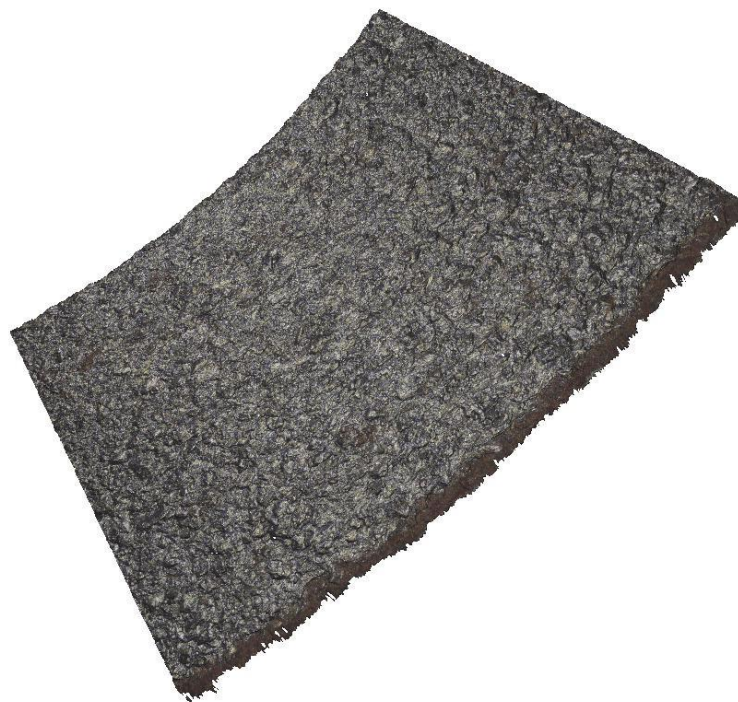
Rys. 49. Profil chropowości 3D dla stali S235 wykonany przy pomocy profilometru marki SENSOFAR.
