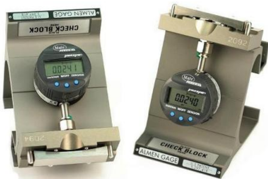
Rys. 3a. Cyfrowy miernik służący do pomiaru ugięcia płytki Almena.
