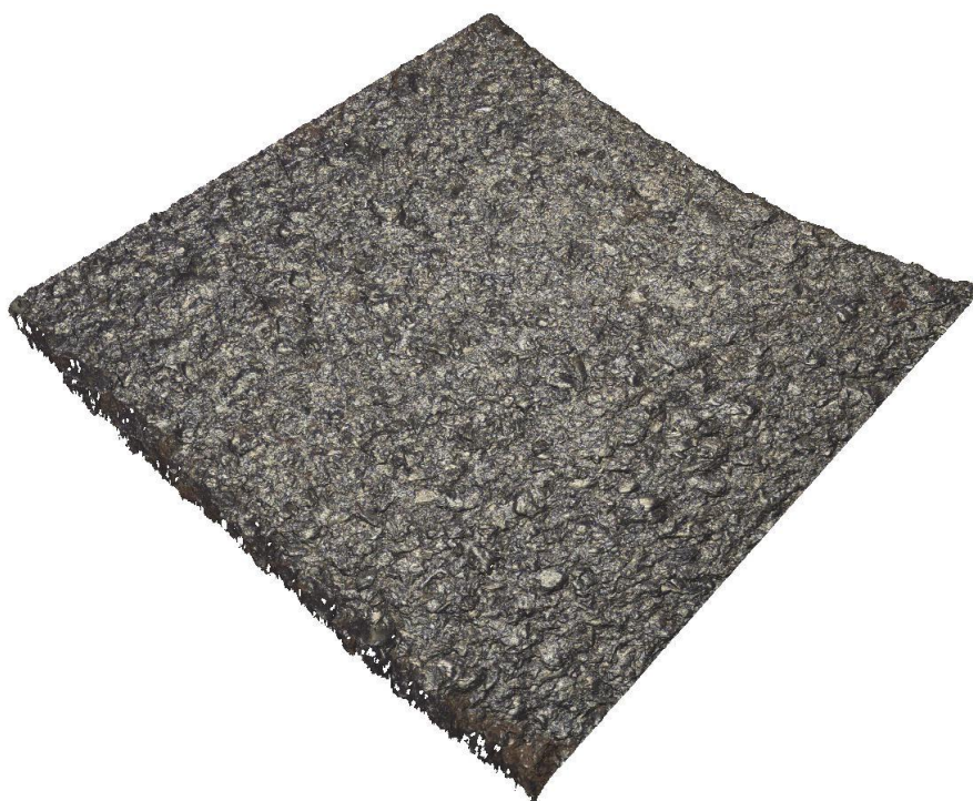
Rys. 51. Profil chropowości 3D dla stali P460 wykonany przy pomocy profilometru marki SENSOFAR.
