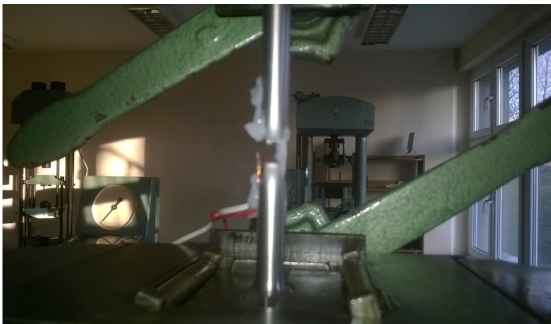
Rys.16. Przyrost długości próbki w trakcie statycznej próby rozciągania, wraz z charakterystycznym przewężeniem.
