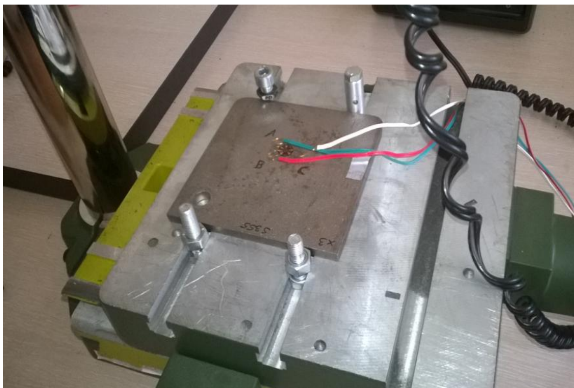
Rys. 34 . Wiercenie otworu pomiarowego przy zastosowaniu rozet tensometrycznych.
