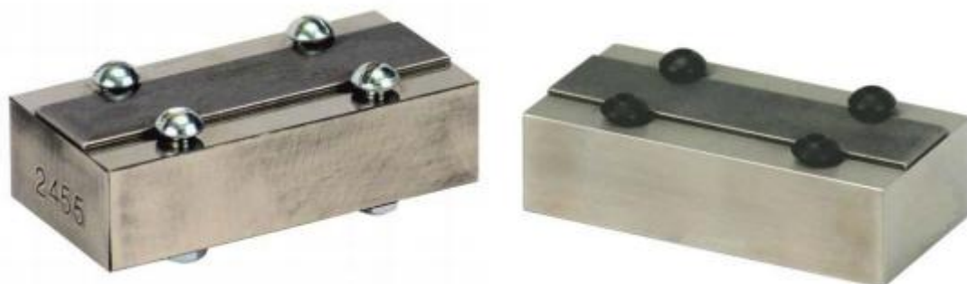
Rys. 3b. stolik z usztywnieniem do pomiaru wybożenia próbek Almena.
