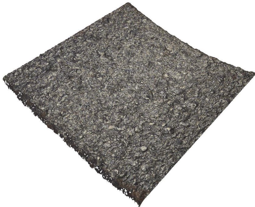
Rys. 50. Profil chropowości 3D dla stali S355 wykonany przy pomocy profilometru marki SENSOFAR.
