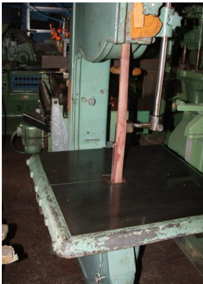
Rys. 11. Sposób wycinania materiału do wykonania próbek z arkusza materiału [146].
