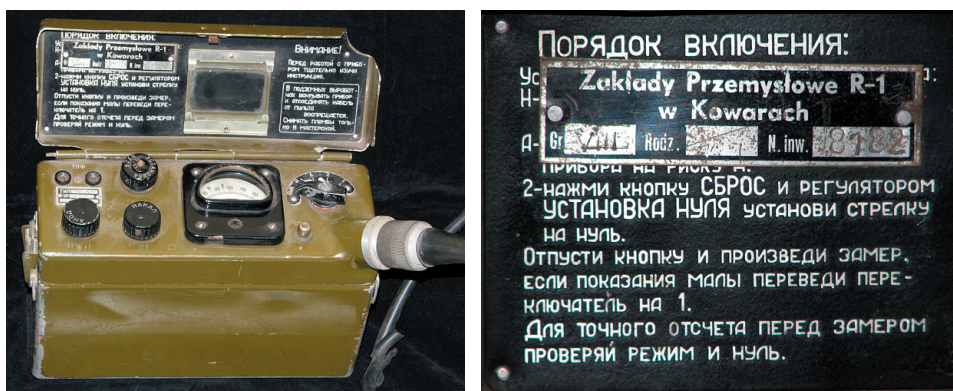
Ryc. 3. Radiometr typu UR-4M z 1955 r. z tabliczką znamionową Zakładów Przemysłowych „R-1” (ze zbiorów Muzeum Mineralów w Nowej Rudzie, fot. R. Borzęcki)
