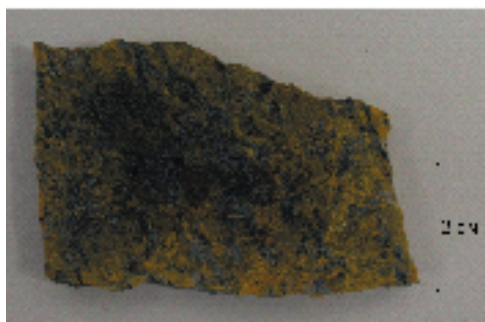
Ryc. 2. Odmiana szaro-oliwkowo-zielona z odcieniem brązowym; zauważalny kierunkowy układ skupień minerałów ciemnych
