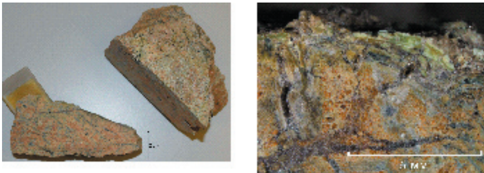
Ryc. 6. Odmiana jasno-brunatno-zielona; po lewej stronie zauważalne pustki wypełnione materiałem krzemionkowym, oraz minerały zielone
