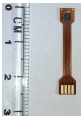
Rysunek 2.3: Czujnik temperatury i wilgotności względnej powietrza SHT31 [99].
