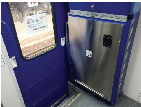
Rys. 9. Winda elektryczno-hydrauliczna w wagonie typu 157Aa: a) podczas jazdy, b) w trakcie korzystania przez osobę niepełnosprawną (źródło: opracowanie własne)
