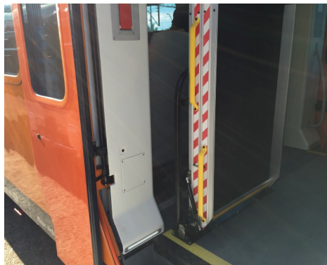
Rys. 6. Złożony podjazd: a) w zmodernizowanym EZTcie FPS Feniks EN57, b) w nowym EZTcie Newag Impuls (źródło: opracowanie własne)
