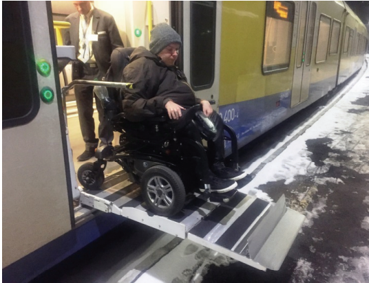
Rys. 8. Drzwi zewnętrzne wyposażone w podnośniki wózków inwalidzkich:
