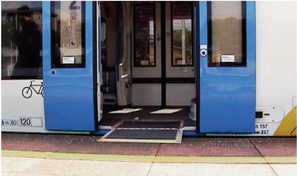
Rys. 5. Rampa zastosowana w Pesa Atribo SA136 (źródło: opracowanie własne)
