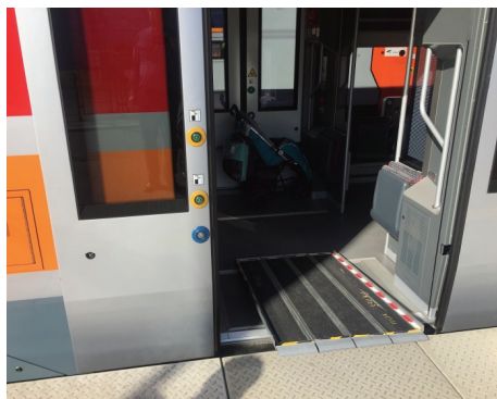
Rys. 7. Rozłożony podjazd: a) w szynobusie Pesa Link SA139, b) w zmodernizowanym wagonie FPS Cegielski (źródło: opracowanie własne)
