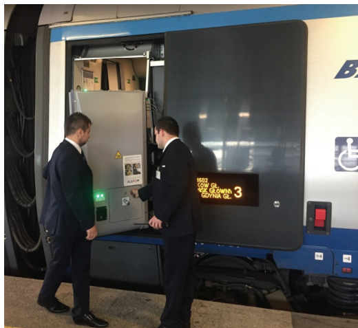
Rys. 10. Winda w ED250 Pendolino podczas rozkładania przez obsługę pociągu (źródło: opracowanie własne)
