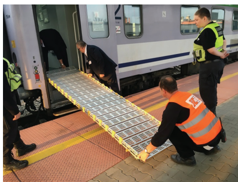
Rys. 7. Rozłożony podjazd: a) w szynobusie Pesa Link SA139, b) w zmodernizowanym wagonie FPS Cegielski (źródło: opracowanie własne)
