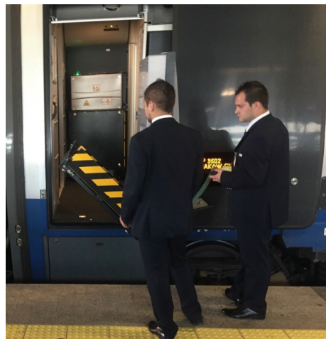
Rys. 10. Winda w ED250 Pendolino podczas rozkładania przez obsługę pociągu (źródło: opracowanie własne)
