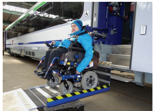
Rys. 9. Winda elektryczno-hydrauliczna w wagonie typu 157Aa: a) podczas jazdy, b) w trakcie korzystania przez osobę niepełnosprawną (źródło: opracowanie własne)
