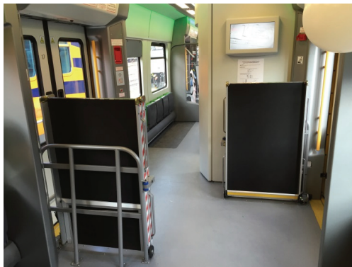
Rys. 6. Złożony podjazd: a) w zmodernizowanym EZTcie FPS Feniks EN57, b) w nowym EZTcie Newag Impuls (źródło: opracowanie własne)
