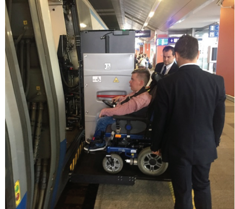
Rys. 8. Drzwi zewnętrzne wyposażone w podnośniki wózków inwalidzkich:
