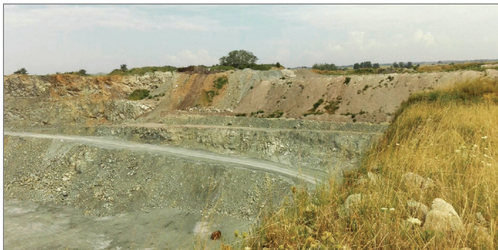
Fot. 44. Kopalnia serpentynitu Nasławice – przykład prowadzenia procesu odzysku poprzez wypełnienie części wyrobiska odpadami obcymi (fot. M. Eliaasz)
