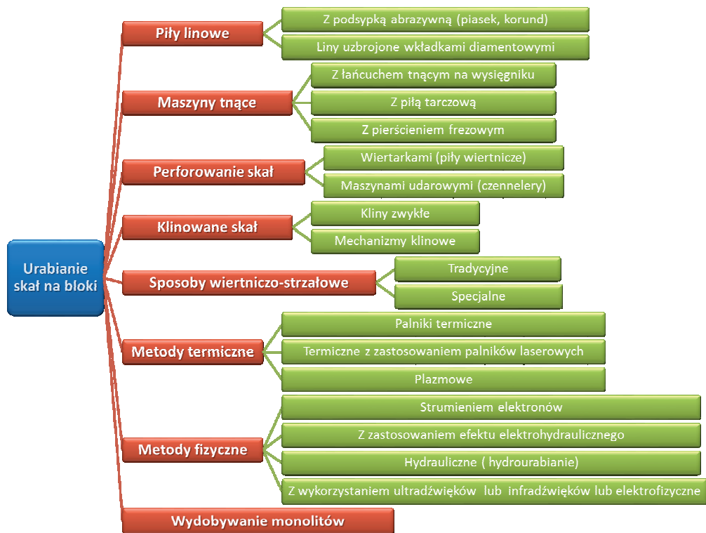
Rys. 24. Metody urabiania skał na bloki (Kasztelewicz 2013)
