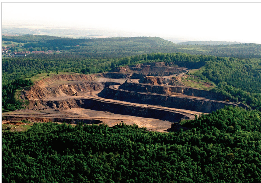
Fot. 11. Zakład Górniczy Krzeniów, woj. dolnośląskie – eksploatacja bazaltu na kruszywo (fot. z zasobów OUG)
