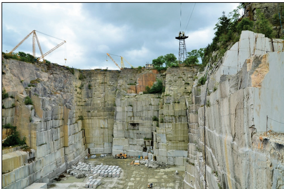
Fot. 7. Wyrobisko kamieniołomu granitu eksploatowanego na bloki, Zakład Górniczy Borów 14, woj. dolnośląskie (fot. M. Ptak)
