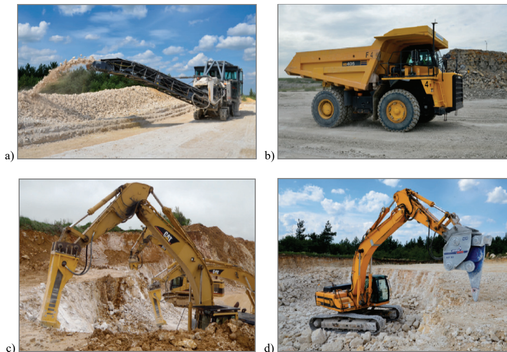
Fot. 38. Źródła emisji hałasu od maszyn urabiających i transportu kołowego: a) kombajn Wirdgen, b) wozidło technologiczne, c) młot hydrauliczny, d) zrywak hydrauliczny (z zasobów OUG)
