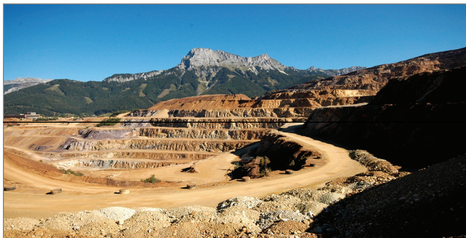
Fot. 33. Poziomy eksploatacyjne kopalni odkrywkowej rud żelaza Schaubergwer Austria (fot. Z. Kasztelewicz)
