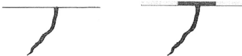
Rys. 2.6. Schemat badania penetracyjnego [27], gdzie: a) pęknięcie powierzchniowe, b) faza penetracji, c) powierzchnia po oczyszczeniu, d) wskazanie od pęknięcia po wywołaniu
