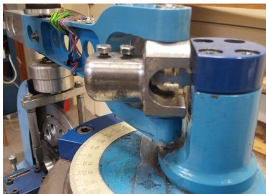
Rys. 4.5. Badanie zmęczeniowe przy zginaniu ze skręcaniem, gdzie: a) próbkę w uchwytach maszyny zmęczeniowej, b) schemat obciążenia
