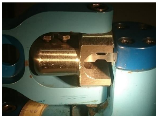
Rys. 4.4. Próbkę w uchwytach maszyny zmęczeniowej poddaną zginaniu
