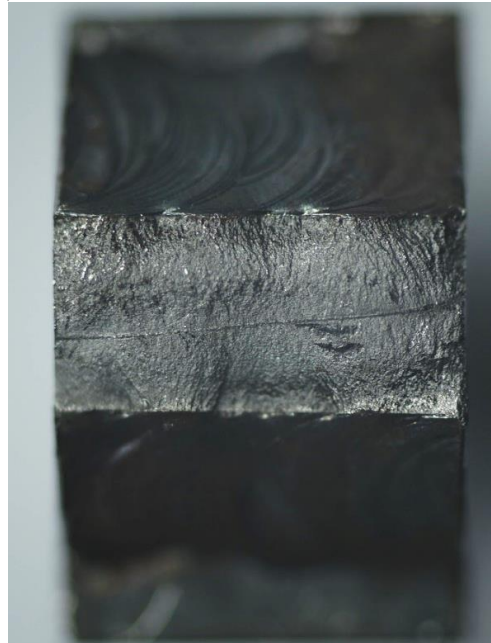
Rys. 4.46. Przykładowe złomy zmęczeniowe przy zginaniu ( R = -1 ) dla próbki: a) litej, b) ze spoinami wklęsłymi, c) ze spoinami wypukłymi
