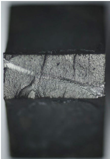
Rys. 4.47. Przykładowe złomy zmęczeniowe przy zginania ( R = -1 ) dla próbki: a) ze spoinami wypukłymi po wyżarzeniu odprężającym, b) ze spoinami wklęsłymi po wyżarzeniu normalizującym, c) ze spoinami po zabiegu technologicznym
