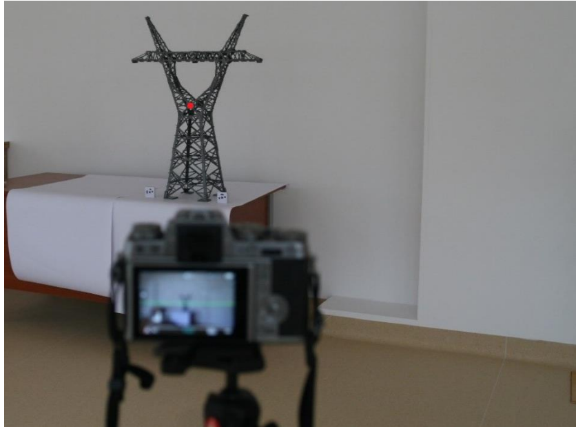
Rys. 4.13. Badany obiekt – wydrukowany model słupa
