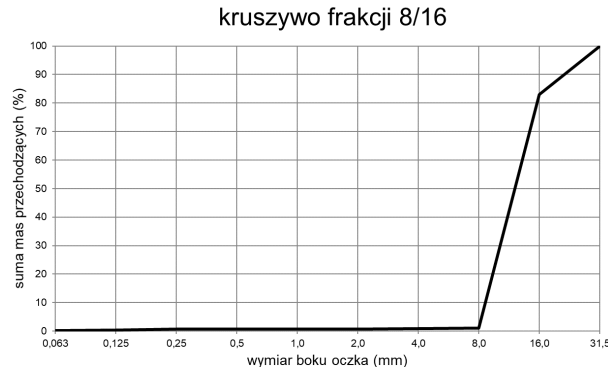
Rysunek 4.6. Uziarnienie frakcji 8/16 kruszywa bazaltowego
